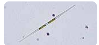
ニッチア (ろ過閉塞を起こしたり、ろ過装置から通過する珪藻類)
