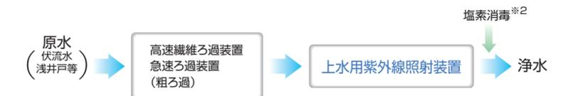
② 浄水処理の安全性を一層高める⇒ろ過装置の後段に紫外線照射装置を
