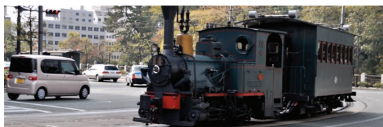
坊っちゃん列車 明治時代に走っていた蒸気機関車をディーゼル車にして観光用で復元。市中心部と道後温泉間を約15分で結んでいる。
