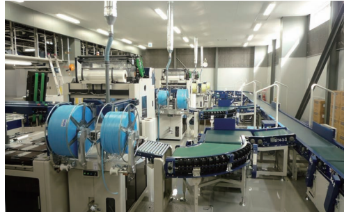
印刷された新聞は自動で梱包され配達のトラックに積み込まれます
