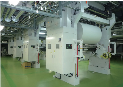
輪転機。高速で回転しながら印刷します
